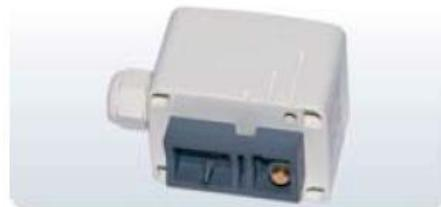
Предназначен для измерения температуры на трубопроводе обратной воды теплообменника. Диапазон измерений: -50 ...+150 °C. Устройство: резисторный измерительный элемент, смонтированный в пластиковом корпусе. Степень защиты: IP54. Для наружного монтажа на трубопроводе, с помощью хомута (в комплекте).
