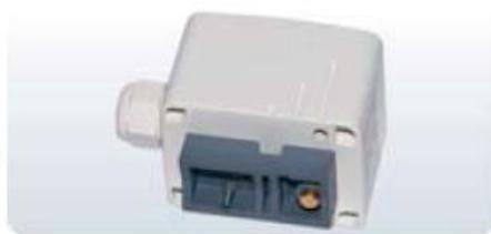
Предназначен для измерения температуры на трубопроводе обратной воды теплообменника. Диапазон измерений: -50 ...+150 °С. Устройство: резисторный измерительный элемент, смонтированный в пластиковом корпусе. Степень защиты: IP54. Для наружного монтажа на трубопроводе, с помощью хомута (в комплекте).
