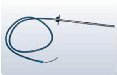
Предназначен для измерения температуры воздуха в канале/измерения температуры приточного, вытяжного или наружного воздуха. Диапазон измерений: -35°C...+100°C. Устройство: резисторный измерительный элемент, смонтированный в алюминиевом зонде. Степень защиты: IP 65. Длина 200мм, диаметр 6мм, длина кабеля 1м, металлический фланец для крепления на воздуховоде.
