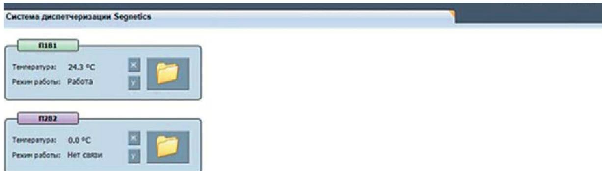
Имеющиеся в системе диспетчеризации вентиляционные установки отображаются в этом окне в виде табличек с названием (например, P1B1, P2B2).
