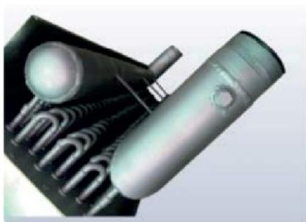
Коллекторы теплообменника – важная часть теплообменника, распределяющего теплоноситель по медным трубкам. На каждом патрубке теплообменника присутствует пробка для слива теплоносителя и продувки теплообменника при консервации на сезон. Важным аспектом является то, что резьба под пробку – трубная, что позволяет вкручивать в них стандартную арматуру (шаровые краны, воздухоотводчики и т.д.)
